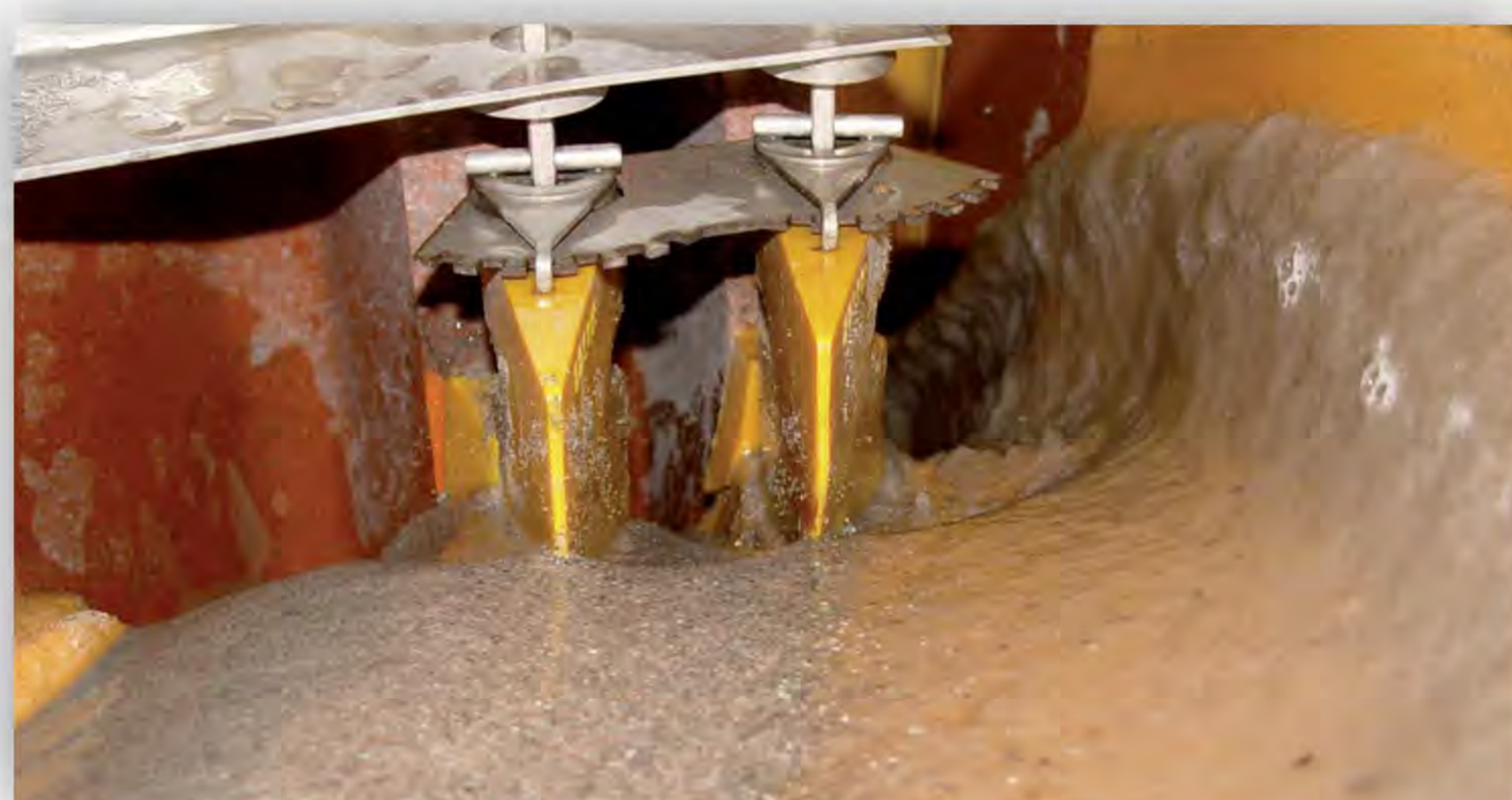
Oddělování písčité složky od kalových složek s obsahem lehkého organického materiálu pomocí nastavitelných hradítek
