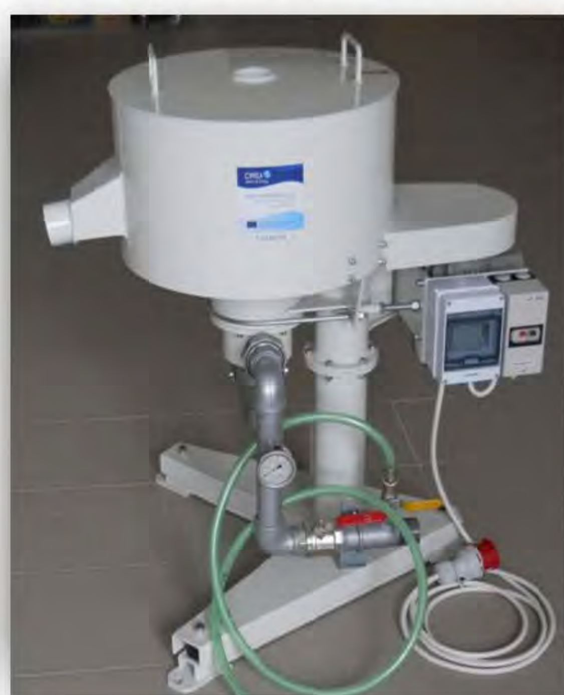
Odstředivý separátor se spodním přívodem tlakové fluidizační vody a horním přívodem separovaného rtuti
