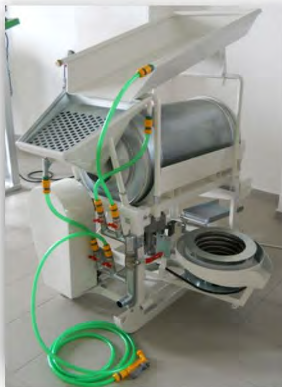
Rozplavovací gravitační zařízení s horní násypkou, rozplavovacím bubnem a výsuvným odstředivým separátorem
